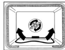
L'élément inférieur fonctionne à pleine puissance durant tout chauffage. L'air dans la cavité du four est attiré vers le centre du ventilateur et poussé autour du déflecteur pour un chauffage uniforme et une cuisson plus rapide.
