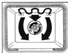
L'élément supérieur fonctionne à pleine puissance durant tout chauffage. Il s'allume et s'éteint par intermittence pour maintenir la température réglée. Le ventilateur fait circuler l'air dans la cavité du four pour un chauffage uniforme.
